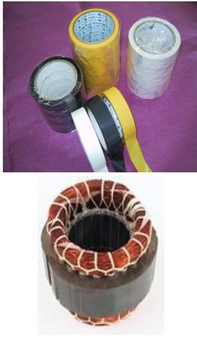
全科 PEN 耐熱絕緣膠帶 已獲 UL 認可, 155°C E117836。使用 Dupont Teijin 公司生產的 PEN (Poly ethylene naphthalene) 薄膜塗佈壓克力膠而成。PEN 耐熱性佳，機械特性可耐 160°C，電氣特性可耐 180°C。高溫尺寸安定性好。耐水性、氧氣穿透率等也都比 PET 都好很多。適合軟性電路板工業當成介電基材，以及需要 F-class 耐熱等級的各種電機、電子零組件，汽車業高溫變壓器之繞捲之用等。也可用於取代高價的 polyimide 膠帶及 polyamide 膠帶。
