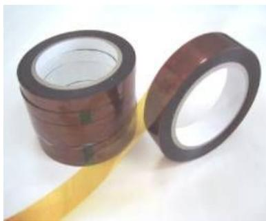
全科 PT-85 PI 耐熱矽膠膠帶是由25 $\mu$  的 polyimide (聚亞醞胺)膜塗佈矽膠而成。耐熱 -40°C~200°C、耐燃、強度好、厚度薄、電氣絕緣性佳。專為變壓器、線圈、電容器等之纏繞固定之用而設計製造，也大量適用於各種軟性印刷電路板的表層使用。
