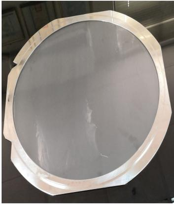
**全科 PT-185** 是專為 LCD 驅動 IC 細長晶條及 Flash IC 薄片等切割製程而特別設計的 UV 切割膠帶。使用特製的 PVC 塗佈 UV 黏膠而成。使晶片於切割過程不飛散、不移位。加工結束後，只要照射適量的紫外線，就可以變成不黏，可以很容易取下而不脫膠。
