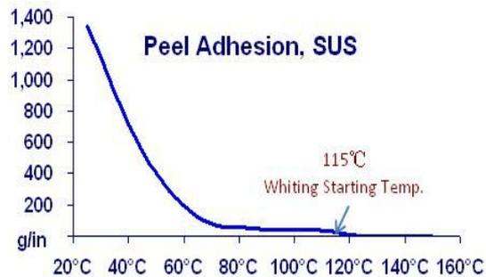
**全科雙面熱解膠膜 DTA1012** 是使用 **100µPET** 為基材，一面是熱解膠膜，另一面是低黏感壓膠。熱解膠膜是一種特製之黏性膠帶，在工作完成後加熱至適當溫度就可自動脫離。專為各類晶片之堆疊、切割、翻轉之用。另一面為感壓膠，可以用來暫時固定此膠膜於玻璃或機台上，方便使用。
