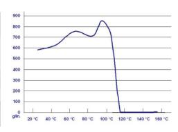
全科雙面熱解膠膜 DTT1012 是使用 100μPET 為基材的膠膜,雙面各塗佈熱解膠而成的膠膜。一種特製之雙面膠帶,在工作完成後加熱至適當溫度就可自動脫離。專為積層陶瓷電容(MLCC)之堆疊、切割、翻轉,以及各類晶片切割、研磨、翻轉之用。 尤其是在一般之UV 解黏膠帶無法達成的工作,經常可藉由熱解膠膜來完成。
